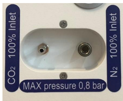
Figure 11.1 Ingressi per il gas sul retro degli incubatori multicamera IVF MIRI® II-12
